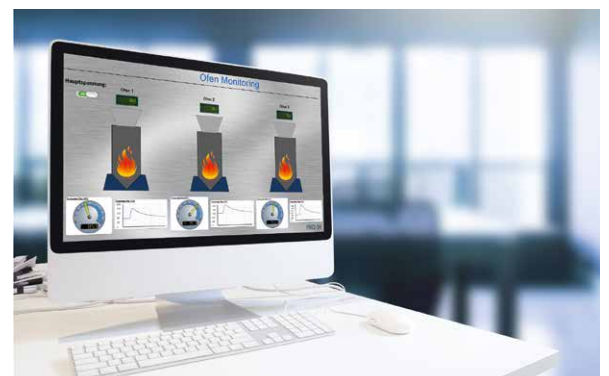
Optimierungspotentiale im Shopfloor erschließen: Das PROXIA Prozessdaten-Modul speichert, verwertet und visualisiert Prozessdaten von Maschinen und Anlagen, wie z.B. Temperaturen, Geschwindigkeiten oder Drücke.
