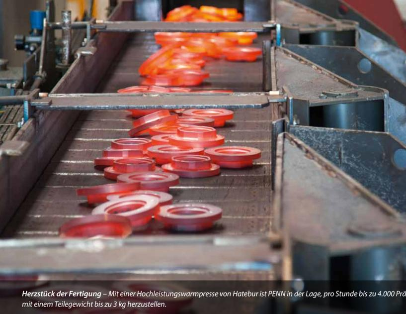
**Herzstück der Fertigung** – Mit einer Hochleistungswarmpresse von Hatebur ist PENN in der Lage, pro Stunde bis zu 4.000 Präzisionsschmiedeteile mit einem Teilgewicht bis zu 3 kg herzustellen.
